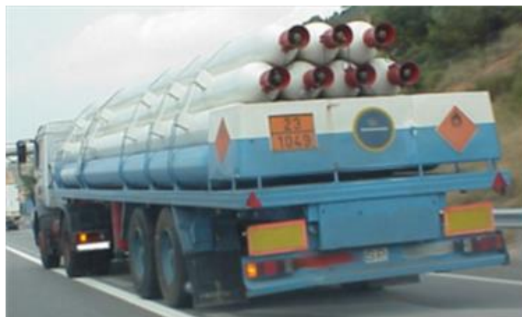
VEHICULO BATERIA FORMADO POR TUBOS
