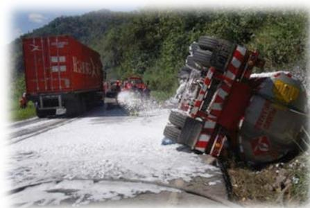
Derrames de gran volumen originados por la rotura de tuberías aéreas, grandes envases, tanques, cubetos de contención, isotanks o camiones cisterna. Dichos derrames son difíciles de contener y retener con sistemas clásicos de absorbentes debido a su gran volumen y pueden llegar a los sistemas de drenaje de pluviales de la planta y salir del establecimiento sin control.
